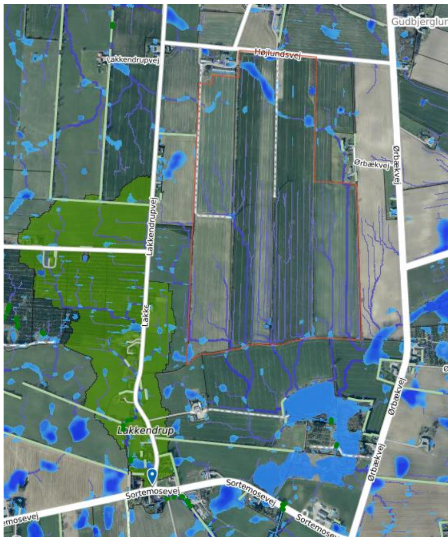
Figur 11-5 Grøn markeret areal angiver vandoplandet der ledes mod lavningen ved krydset Lakkendrupvej og Sortemosevej. Projektområdet er omridset med rød streg
